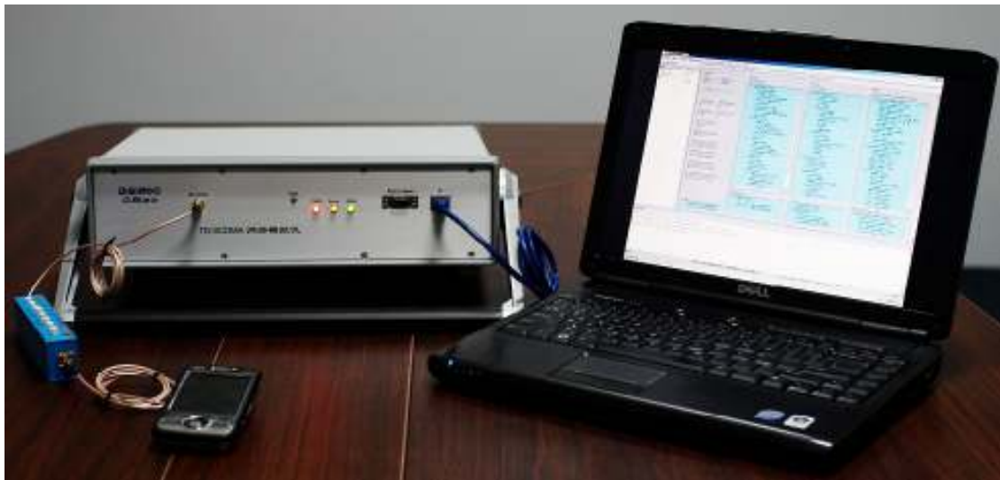
图 1 TD-SCDMA 网络模拟仪系统
